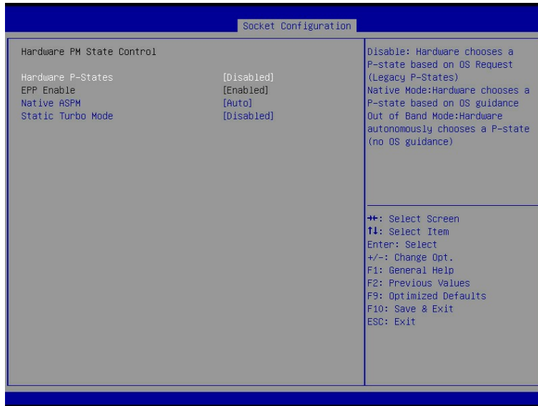
图 3-42 Hardware PM State Control 界面
